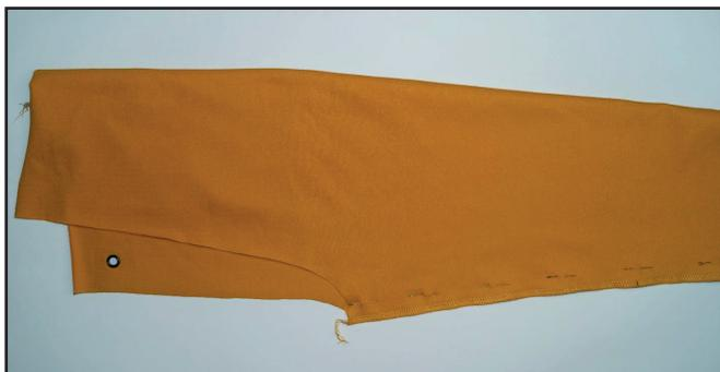
Скалываем булавками шаговые швы брючин лицевыми сторонами внутрь. Стачиваем срезы на оверлоке. Припуски заутюживаем на передние половинки брюк.
