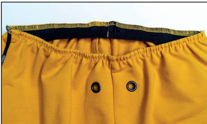
Делим резинку на 4 части. Совмещаем эти метки с центральными и боковыми швами пояса брюк. Прикалываем резинку к изнаночной стороне брюк и притачиваем ее на оверлоке. При притачивании резинку равномерно натягиваем.
