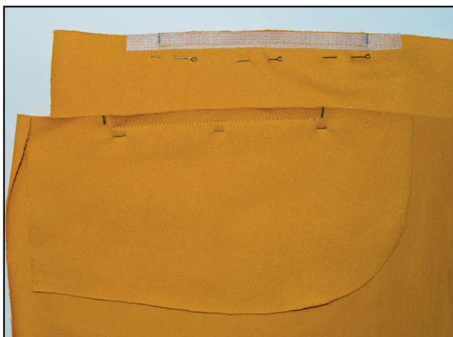
Прикалываем булавками мешковины карманов к передним половинкам брюк лицом к лицу, совмещая метки. Прокладываем прямую строчку на расстоянии 8 мм от края от метки до метки. Делаем надсечки по краям шва.
