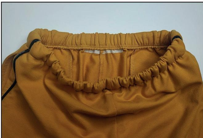
Прикалываем булавками или приметываем верхние срезы мешковин кармана. Подворачиваем пояс внутрь на ширину резинки. Равномерно натягивая, отстрачиваем резинку на расстоянии 2,5 см от края.
