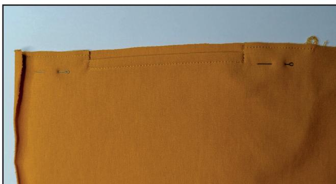
На концах входа в карман прокладываем две поперечные строчки. Также фиксируем мешковины строчками выше и ниже входа в карман прямыми строчками на расстоянии 4 мм от края.
