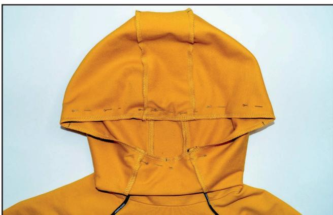
Вкладываем капюшон в подкладку капюшона лицом к лицу. Скалываем булавками, совмещая метки. Стачиваем срез на оверлоке. Выворачиваем капюшон и заутюживаем шов, образуя перекант.
