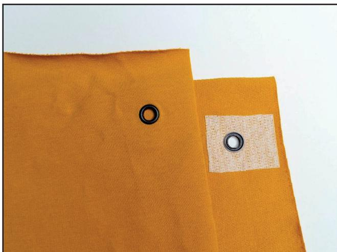
Пробиваем отверстия под люверсы диаметром 4,5 мм с помощью пробойника или ножниц. Устанавливаем люверсы с помощью пресса.
