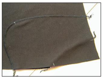
Скалываем булавками мешковину кармана и бочок лицевыми сторонами внутрь, стачиваем их на оверлоке. То же выполняем со вторым карманом. Швы утюжим на ребро.
