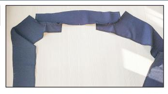
Обметываем на оверлоке свободный край и плечевые срезы подбортов. Затем сметываем подборта с воротником, совмещая метки. Прошиваем прямой строчкой. Делаем рассечки по всему шву через каждые 1,5-2 см, не доходя 1 мм до строчки. Припуски швов разутюживаем.
