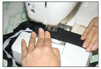
Равномерно натягивая резинку, прокладываем прямую строчку на расстоянии 1 см от сгиба пояса. Затем параллельно прокладываем вторую строчку на расстоянии 1 см от предыдущей.
