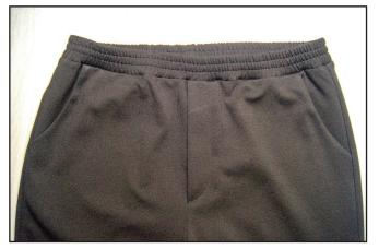
Натягивая пояс, притачиваем его на оверлоке. При этом следим, чтобы ткань самих брюк при притачивании не растягивалась. Шов заутюживаем на брюки.
