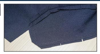
Срезаем припуски на уголках, срезаем припуск верхнего воротника в 2 раза для уменьшения толщины, на закруглениях делаем надсечки, не доходя до шва на 1 мм.
