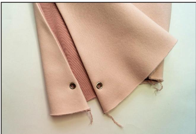
Пробиваем отверстия под люверсы диаметром 3 мм с помощью пробойника или ножниц. Устанавливаем люверсы с помощью пресса.
