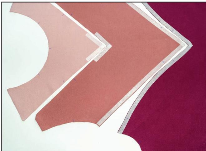
Отрезаем несколько кусочков кантенбанда длиной 60 мм. Проклеиваем кантенбандом уголки верхней, средней и нижней деталей спинки и полочки. Если планируете сделать секреты для кормления, то припуски срезов стачивания средней и нижней частей полочки проклеиваем кантенбандом полностью.
