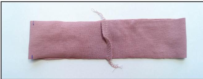
Чтобы избежать излишнего утолщения при притачивании обтачки горловины, концы припусков заутюживаем в разные стороны.
