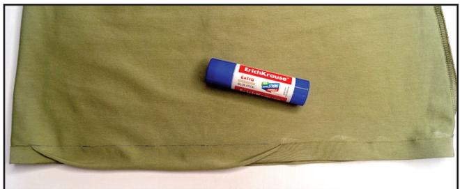
Чертим по низу топа линию на расстоянии 40 мм от края. С ее помощью подгибаем низ на 20 мм. Фиксируем подгибку булавками, наметочным швом или клеем-карандашом. Утюжим низ топа.
