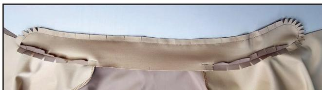
Делаем треугольные надсечки припусков вдоль закруглений, не доходя 1 мм до шва.
