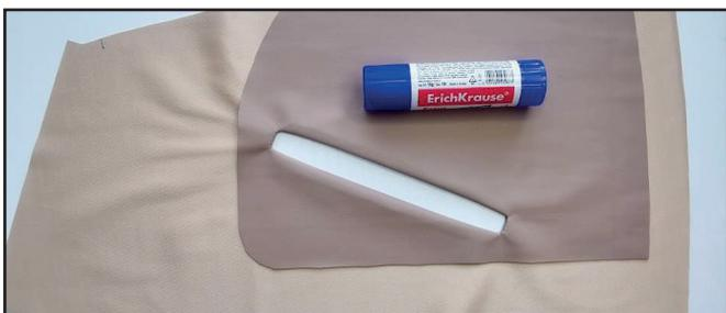
Выворачиваем карман на изнаночную сторону. Утюжим, образуя перекант. Если карман плохо фиксируется, то можно на изнанке вдоль рамки проклеить мешковину клеем-карандашом или скотчем для кожи.
