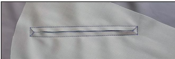
Разрезаем бочок переда и мешковину кармана внутри рамки вдоль линии. На концах рамки делаем надсечки наискосок к углам. Будьте внимательны, не разрежьте строчку!
