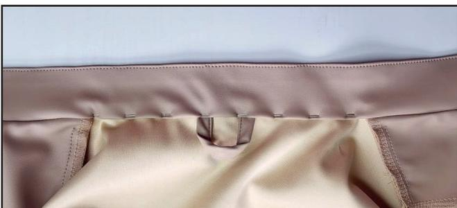
Прикалываем нижнюю часть стойки к горловине спинки так, чтобы ее край закрывал шов притачивания. Булавки вкалываем с лицевой стороны, стараясь попадать точно в шов притачивания.
