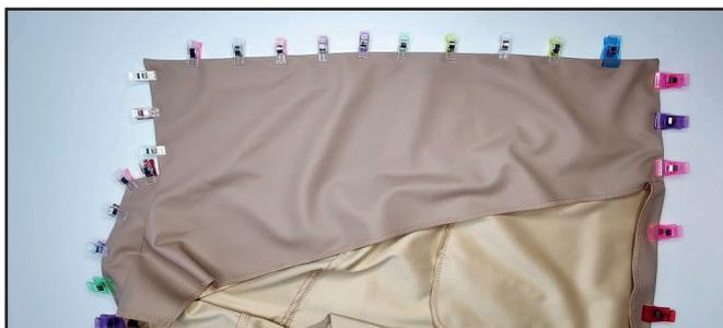
Утюжим и фиксируем края полочек, стойку и подгибку низа. Низ куртки подгибаем на 30 мм. Нижний срез мешковины кармана должен попасть внутрь подгибки и подборта. Край подгибки должен совпадать с нижним краем кармана.
