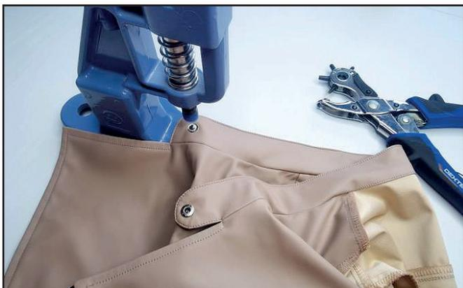
Переносим разметку кнопки с выкройки на стойку. Пробиваем отверстие диаметром 2 мм с помощью пробойника или ножниц. Устанавливаем кнопку с помощью пресса.
