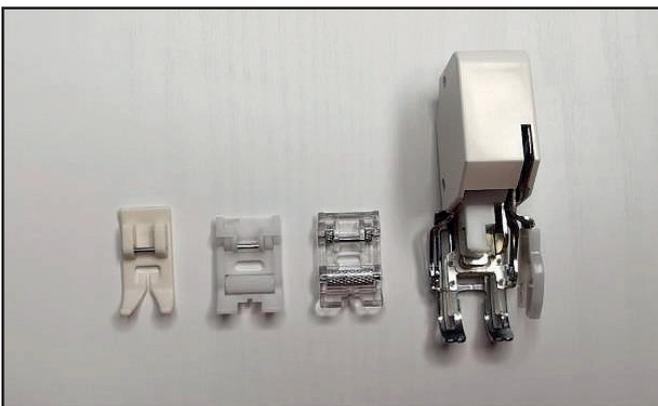
С изнаночной стороны замша и экокожа легко шьются стандартными лапками. С лицевой же стороны могут образовываться складки, мельчить стежок (из-за того, что ткань прилипает к лапке и продвигается неравномерно). Облегчить шитье могут специальные лапки: тефлоновая, лапка с роликом, шагающая лапка. При отсутствии таких лапок для шитья экокожи можно смазывать универсальную лапку
