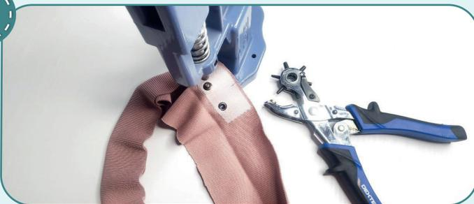
Пробиваем отверстия под люверсы диаметром 2 мм с помощью пробойника или вырезаем при помощи ножниц. Устанавливаем люверсы с помощью прессы.
