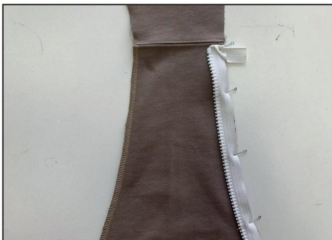
Расстегните длинную молнию. Сколите одну ее тесьму с передом вдоль среза под молнию. Приколите молнию от шва втачивания обтачки до бокового шва лицом к лицу детали переда. Верхний конец молнии отверните на изнаночную сторону.
