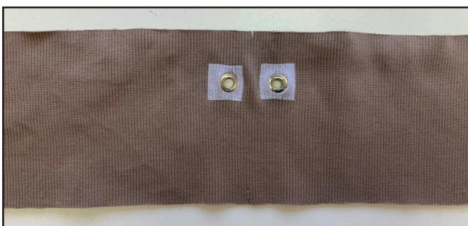
Пробейте отверстия и установите люверсы по разметке.
