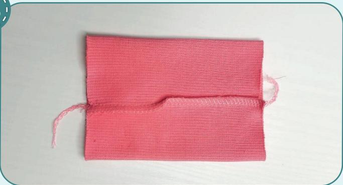
Чтобы избежать излишнего утолщения при притачивании манжет, концы припусков заутюживаем в разные стороны.
