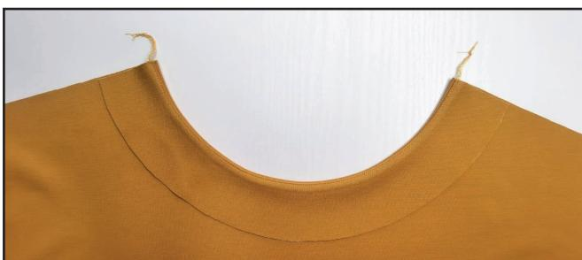
Заутюживаем обтачку на изнаночную сторону, образуя перекант на сторону обтачки.
