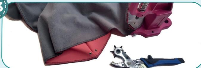
Пробиваем отверстия под люверсы диаметром 3 мм с помощью пробойника или вырезаем при помощи ножниц. Устанавливаем люверсы с помощью пресса.
