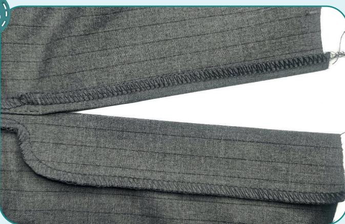
Открытый центральный срез левой части брюк подгибаем на 10 мм на изнаночную сторону и приутюживаем. Гульфик на правой части брюк заутюживаем по линии перегиба.
