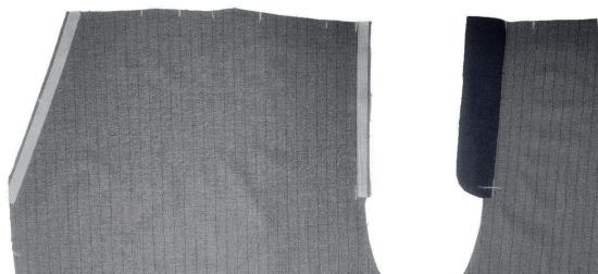
Проклеиваем кантенбандом вход в карман на передних частях брюк и место притачивания молнии на передней левой части брюк. Дублируем откосок, передние части пояса и область гульфика на передней правой части брюк.
