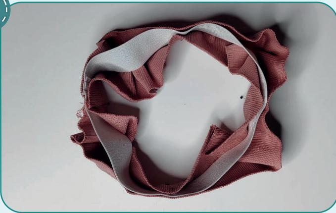
Резинку делим на 4 равных части, отмечаем деления булавками. Вкладываем резинку внутрь пояса, совмещаем метки на резинке с метками на поясе и скалываем в этих местах булавками. Чтобы избежать лишних утолщений, не совмещайте швы стачивания резинки и пояса.
