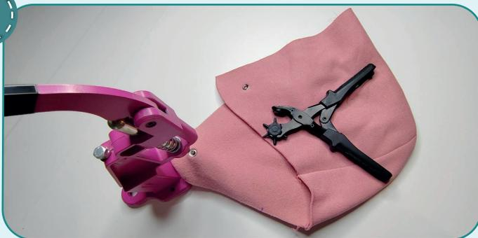
Пробиваем отверстия под люверсы диаметром 3,5 мм с помощью пробойника или вырезаем с помощью ножниц. Устанавливаем люверсы с помощью пресса.
