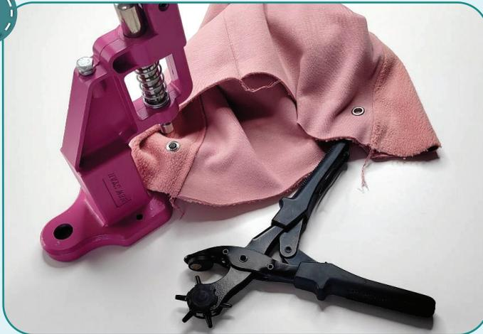
Пробиваем отверстия под люверсы диаметром 3,5 мм с помощью пробойника или вырезаем с помощью ножниц. Устанавливаем люверсы с помощью пресса.
