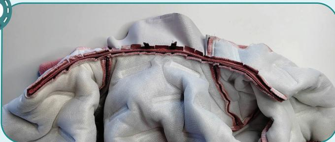
Надсекаем припуски подкладки и верха бомбера каждые 15 мм, не доходя 1 мм до строчки. Припуски воротника-стойки не надсекаем. Припуски капюшона для уменьшения толщины срезаем до 3-4 мм.
