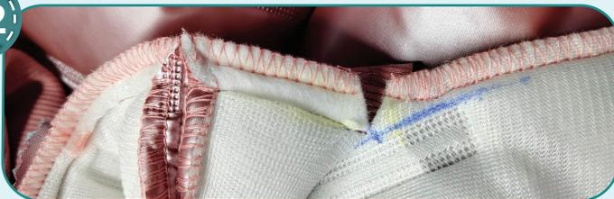
Надсекаем уголок переда, не доходя 1 мм до строчки притачивания пояса. Таким же образом надсекаем уголок второй половины переда.
