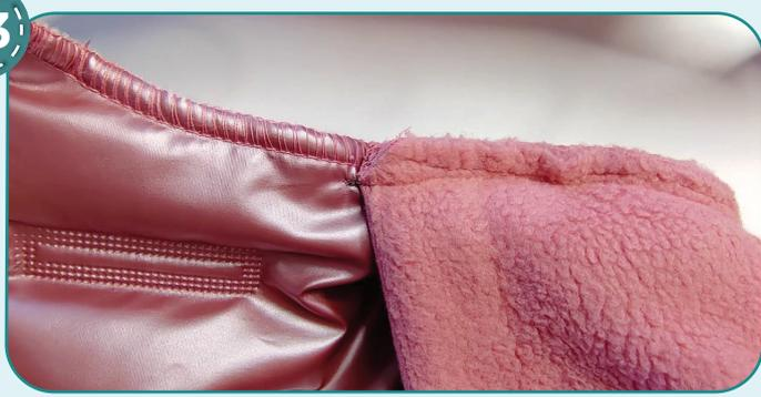
Уголки припусков капюшона и воротника, выступающие за линию перегиба, срезаем.
