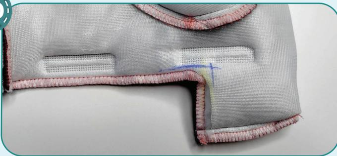
Размечаем в углах деталей пояса и переда припуски.
