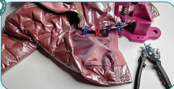
Фиксируем прищепками или булавками перегибы подбортов. Переносим разметку для кнопок на правую половинку переда. Пробиваем сначала отверстия для кнопок диаметром 2 мм с помощью дырокола (или вырезаем с помощью ножниц) на правой половинке переда. Закалываем булавками правую половинку переда вверх левой, совмещая рисунок стёжки, а также верхние и нижние
