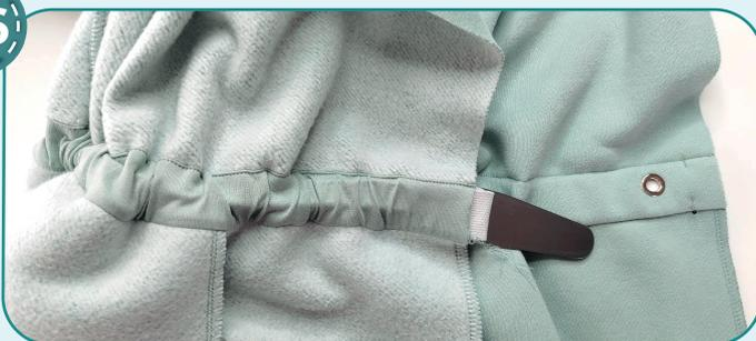
Отрезаем резинку шириной 30 мм и длиной, указанной на выкройке. Вдеваем резинку в кулиску с помощью резинковдевателя или бельевой булавки. Фиксируем концы резинки булавками.
