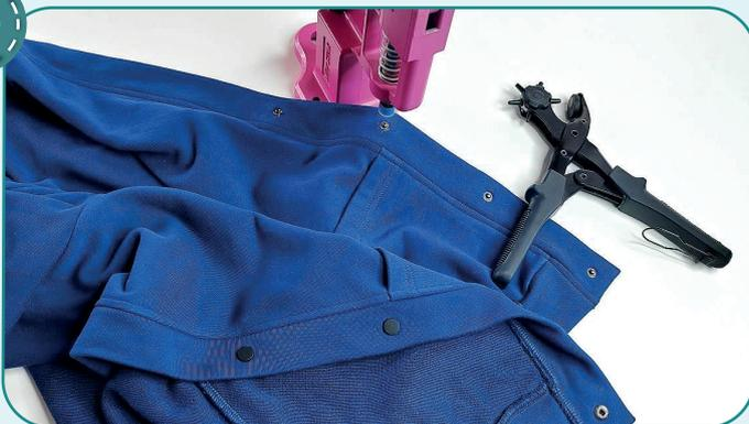
Переносим разметку для кнопок симметрично на обе стороны планки (следим чтобы пояс и карманы находились на одном уровне). Пробиваем сначала отверстия для кнопок диаметром 2 мм с помощью дырокола (или вырезаем с помощью ножниц). Устанавливаем кнопки с помощью пресса таким образом, чтобы при застёгивании левая полочка была поверх правой.
