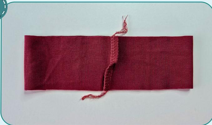
Заутюживаем концы припусков в разные стороны, чтобы избежать излишнего утолщения при притачивании обтачки.
