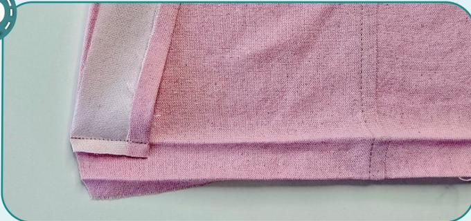
Срезаем уголок припуска, не доходя 1 мм до строчки. Срезаем припуск подборта до 7 мм. Выворачиваем на лицевую сторону. Аналогично обрабатываем второй подборт (п.28-29).
