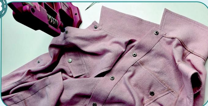
Переносим метки расположения кнопок на полочки и клапаны. Пробиваем отверстия диаметром 1-2 мм с помощью пробойника или шила. Устанавливаем кнопки с помощью пресса. На клапаны устанавливаем верхние части кнопок насквозь, скрепляя таким образом клапан и полочку.
