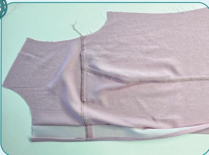
Заутюживаем центральный срез полочки на изнаночную сторону на 10 мм, а затем еще на 40 мм. Аналогично обрабатываем вторую полочку.
