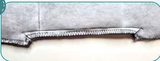
Делаем надсечки припусков полочки наискосок, не доходя 1 мм до концов строчки притачивания молнии.
