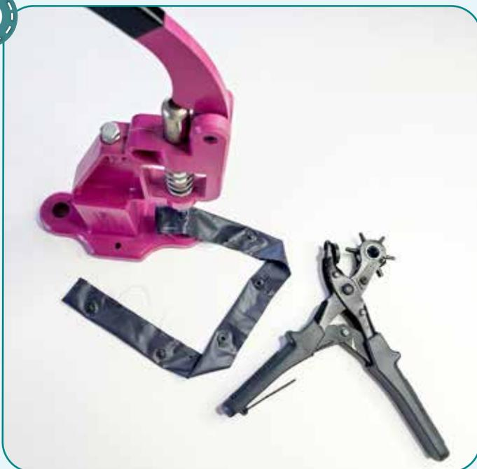
Выворачиваем планку капюшона на лицевую сторону. На лицевую сторону планки переносим разметку местоположения кнопок. Скальваем или смётываем, совмещая нижние срезы, чтобы избежать смещения. Пробиваем отверстия диаметром 1–2 мм с помощью пробойника или вырезаем с помощью ножниц. Устанавливаем нижние части кнопок.
