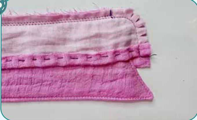
Вдоль закругления делаем V-образные надсечки каждые 4-5 мм.
